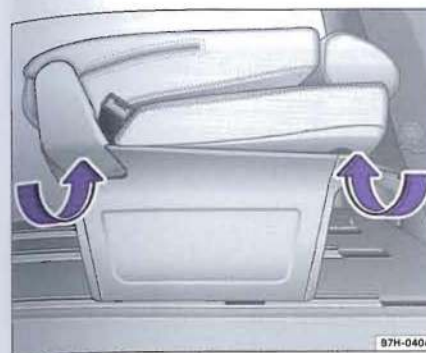
Obr. 79 Trojsedadlo: výchozí body demontáže a montáže
