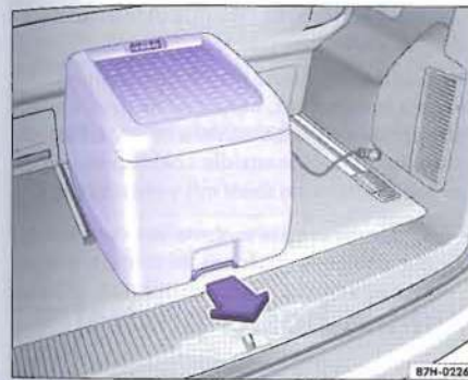
Obr. 99 Demontáž izolačního boxu
