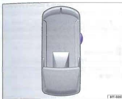
Obr. 15 Základní deska: odjišťovací tlačítko k odejmutí držáku telefonu
