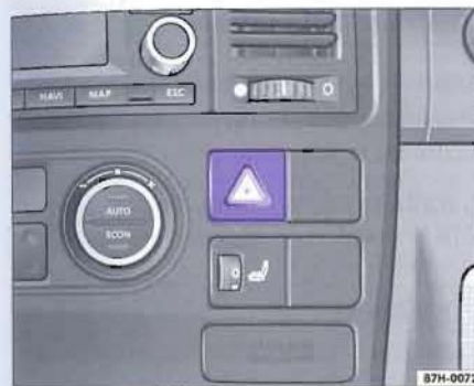
Obr. 41 Přístrojová deska: spínač varovných světel
