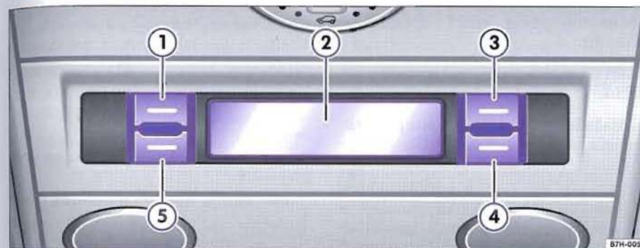
Obr. 124 Pohled střechy: ovládací prvky přídavného vodního topení
