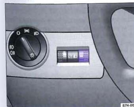
Obr. 39 Přístrojová deska: regulátor osvětlení přístrojů a spínačů a regulace sklonu světel
