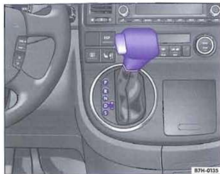
Obr. 131 Přístrojová deska: volicí páka s blokovacím tlačítkem
