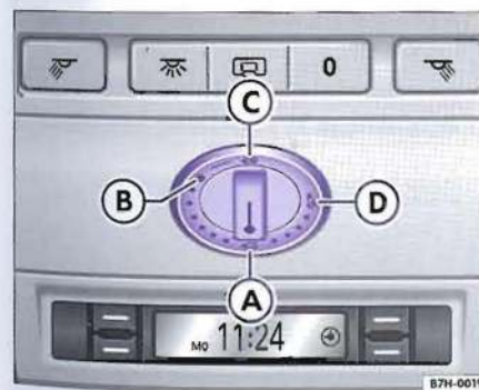
Obr. 37 Podhled střechy: otočný spínač posuvné a výklopné střechy
