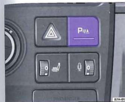
Obr. 139 Přístrojová deska: tlačítko pro zapnutí, resp. vypnutí kontroly vzdálenosti při parkování
