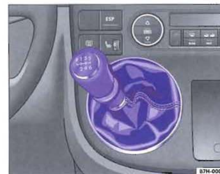
Obr. 134 Řadící páka se schématem řazení pro šestistupňovou ručně řazenou převodovkou
