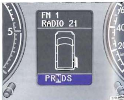
Obr. 130 Sdružené přístroje: displej s ukazatelem rychlostních stupňů
