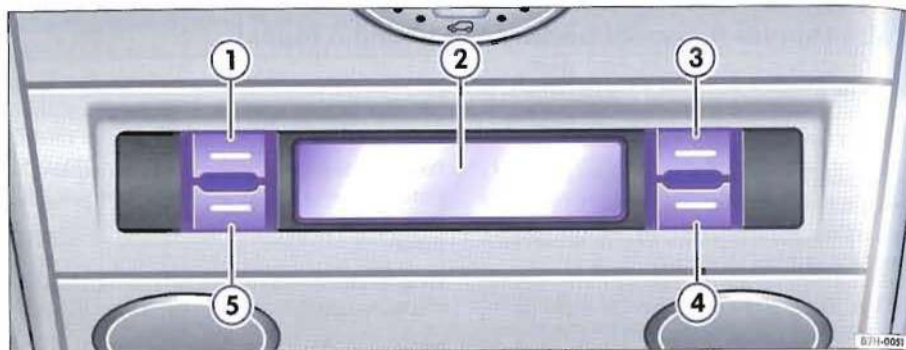
Obr. 126 Pohled střechy: ovládací prvky přídavného vodního topení
