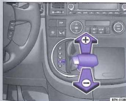
Obr. 132 Přístrojová deska: volící páka v poloze tiptroniku
