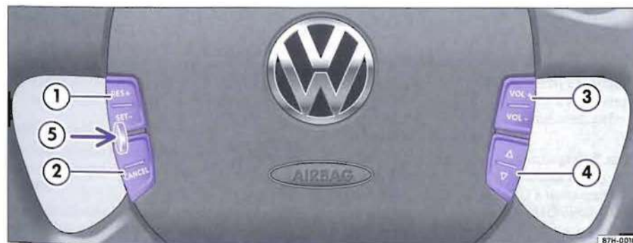
Obr. 5 Multifunkční volant: ovládací prvky pro zvukovou soustavu a regulaci rychlosti (tempomat)
