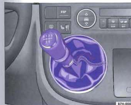
Obr. 133 Řadící páka se schématem řazení pro pětistupňovou ručně řazenou převodovkou
