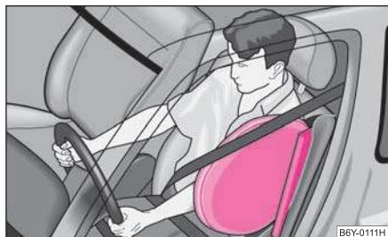
Obr. 169 Plynem naplněné boční airbagy
