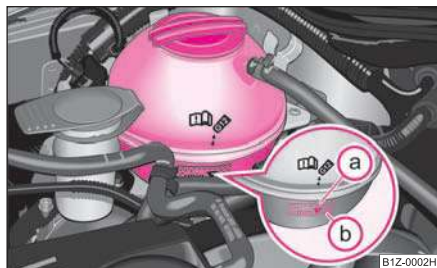
Obr. 199 Motorový prostor: nádržka chladicí kapaliny
