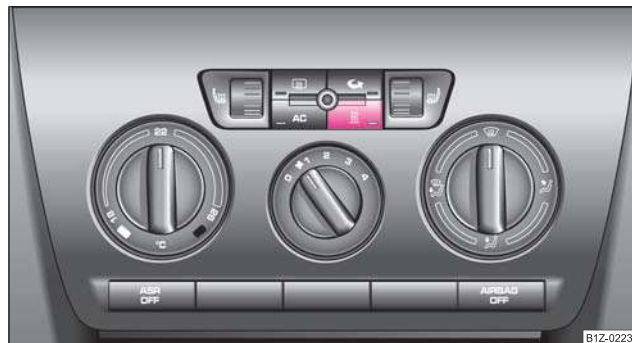
Obr. 129 Tlačítko pro přímé zapnutí (vypnutí) nezávislého přídavného topení a větrání na panelu ovládání Climaticu
