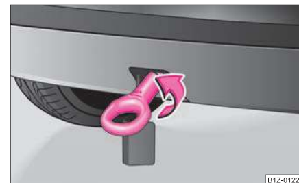
Obr. 221 Zadní nárazník: montáž vlečného oka
