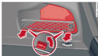
Obr. 221 Pravé boční obložení v zavazadlovém prostoru: demontáž obložení
