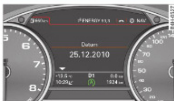
Obr. 89 Sdruzžené přístroje: vypnutí motoru (fáze stop)
