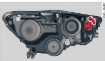
Obr. 272 Světlo: kryt ukazuje směr jízdy
