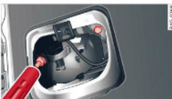
Obr. 285 Demontáž zadního světla v kapotě zavazadlového prostoru
