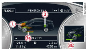
Obr. 96 Sdružené přístroje: ukazatel toku energie
