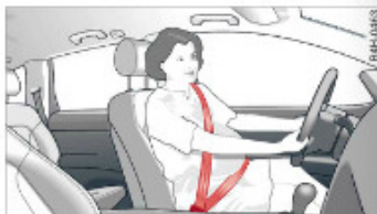
Obr. 200 Vedení bezpečnostního pásu u připoutané těhotné ženy
