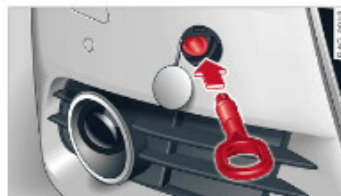
Obr. 257 Přední nárazník: našroubování vlečného oka
