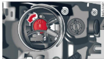
Obr. 269 Světlomet: demontáž žárovky denního svícení / dálkového světla
