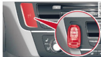
Obr. 86 Středová konzola/rádlový klíček: startování motoru při závadě
