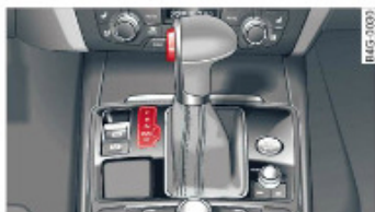
Obr. 108 Středová konzola: volicí páka s blokovacím tlačítkem
