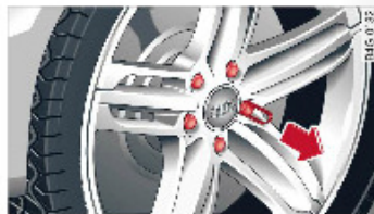
Obr. 247 Výměna kola: sejmout krytek
