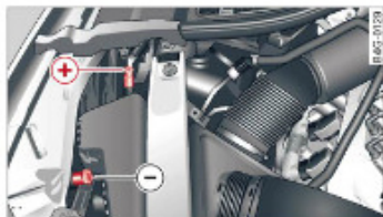
Obr. 233 Motorový prostor: vývod pro připojení nabíječky k startovacímu kabelu
