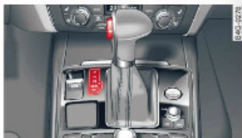
Obr. 100 Středová konzola: volič páky s blokovacím tlačítkem
