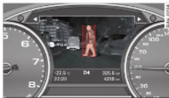
Obr. 142 Sdružené přístroje: varování před chodci
