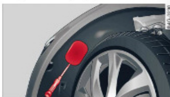
Obr. 266 Ochranná vložka blatníku vpředu: přístup k tlumenému světlu
