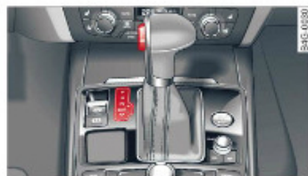
Obr. 114 Středová konzola: volič páka s blokovacím tlačítkem
