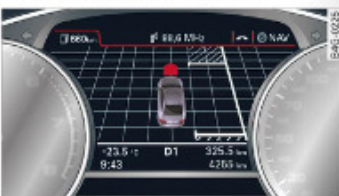
Obr. 178 Sdružené přístroje: místo k zaparkování rozpoznáno, s pokynem k pokračování v jízdě
