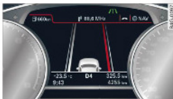
Obr. 131 Sdruzžené přístroje: systém active lane assist je zapnutý a probíhá varování
