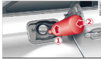
Obr. 225 Plnicí hrdlo AdBlue: nasazení plnicí láhve
