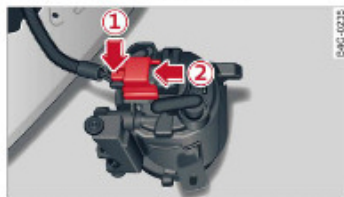
Obr. 279 Míhový světlo: odpojení konektorového spojení
