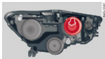
Obr. 268 Světlomet: sajmnutí gumové krytky
