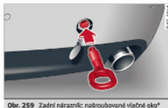
Obr. 259 Zadní nárazník: našroubování vlečného oka*
