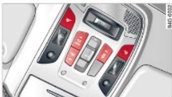
Obr. 42 Podhled střechy vpředu: ovládací prvky vnitřního osvětlení
