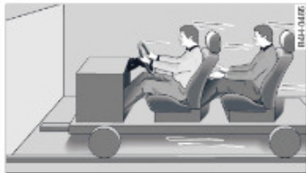
Obr. 193 Vozidlo s nepřípoutanými osobami jedoucí proti zdi
