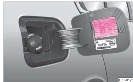
Obr. 195 Otevřený kryt hrdla palivové nádrže s tabulkou rozměrů a tlaků v pneumatikách
