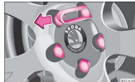
Obr. 202 Stažení krytky šroubu kola
