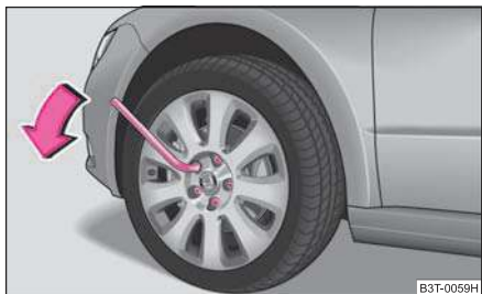
Obr. 204 Výměna kola: povolení šroubů
