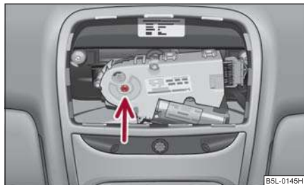
Obr. 53 Výřez z pohledu stropu: nouzové ovládání
