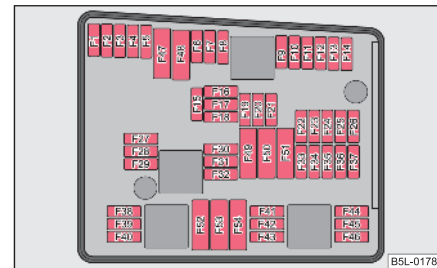
Obr. 234 Schématické zobrazení pojistkového boxu v motorovém prostoru - provedení 1
