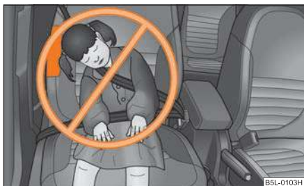
Obr. 182 Nesprávně zajištěné dítě na sedadle v poloze, ve které je ohroženo bočním airbagem
