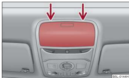
Obr. 52 Výřez z pohledu stropu: místa k nasazení šroubováku
