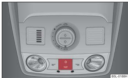
Obr. 62 Výřez z pohledu stropu: světla pro čtení vpředu ve svítlně s integrovaným hlídáním vnitřního prostoru
