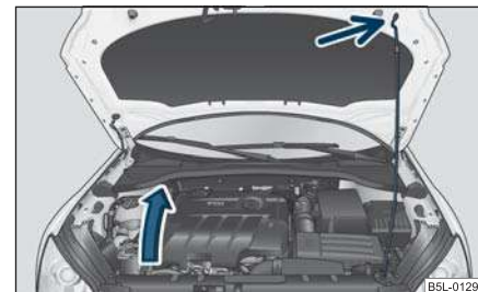
Obr. 206 Zajištění víka motorového prostoru vzpěrou
