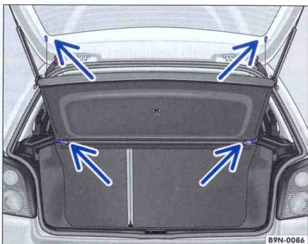
Obr. 48 Demontáž a montáž krytu zavazadlového prostoru
