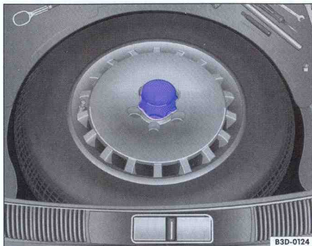
Obr. 20 Rezervní kolo pod krytem podlahy zavazadlového prostoru
