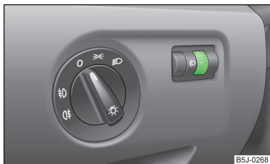
Obr. 41 Přístrojová deska: nastavení sklonu světlometů
