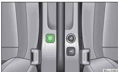
Obr. 135 Tlačítko nastavení kontrolní hodnoty tlaku v pneumatikách
