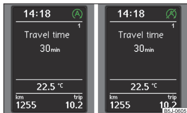
Obr. 115 Displej MAXI DOT: motor je automaticky vypnutý / automatické vypnutí motoru není možné
