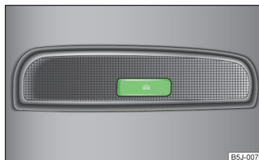
Obr. 47 Vnitřní osvětlení vozidla vzadu
