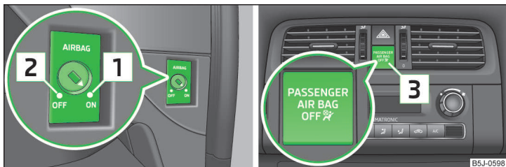
Obr. 12 Vypínač čelního airbagu spolujezdce / Kontrolní světlo vypnutého, resp. zapnutého airbagu spolujezdce
