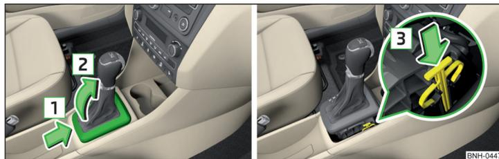
Obr. 164 **Nouzové odblokování volicí páky**
