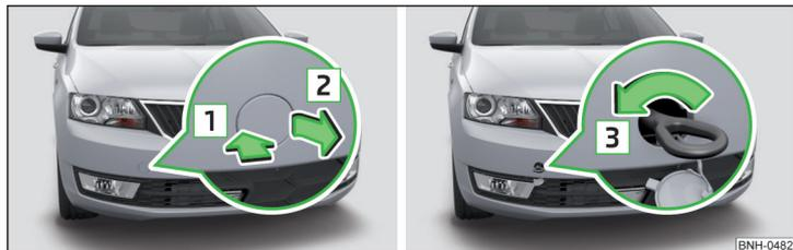
Obr. 159 Demontáž krytky / Montáž vlečného oka
