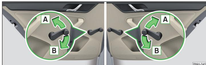
Obr. 41 Ovládání oken: vlevo/vpravo
