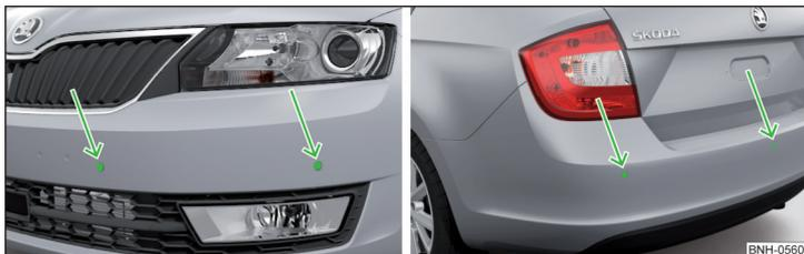
Obr. 107 Umístění snímačů: vpředu/vzadu
