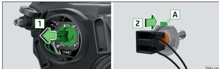
Obr. 173 Výměna žárovky potkávacího světla
