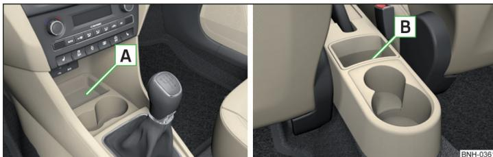
Obr. 66 Neuzavíratelná odkládací schránka vpředu/vzadu
