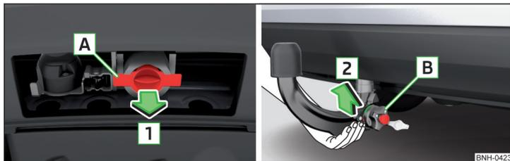
Obr. 125 Vyjmutí krytky otvoru upínacího pouzdra / Nasazení tažného ramena
