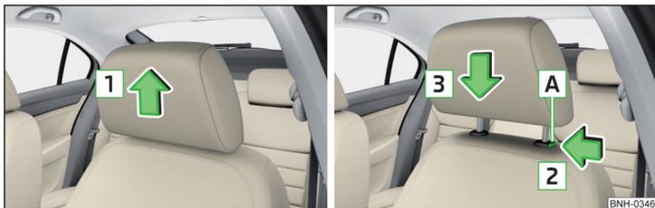
Obr. 57 Hlavové opěrky: posun nahoru / posun dolů
