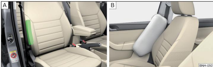
Obr. 9 Umístění bočního airbagu v předním sedadle / Plynem naplněný airbag
