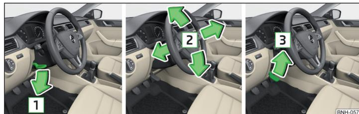
Obr. 2 Nastavení polohy volantu
