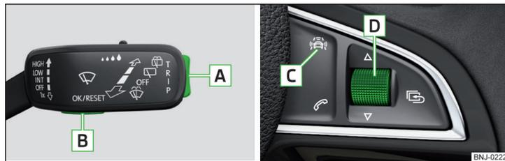
Obr. 118 Tlačítka: na ovládací páčce / na multifunkčním volantu
