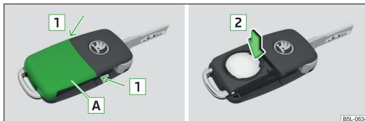
Obr. 161 Demontáž krytu / Vyjmutí baterie
