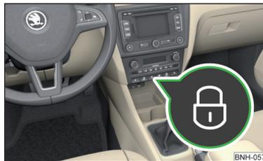
Obr. 36 Spínač centrálního zamykání
