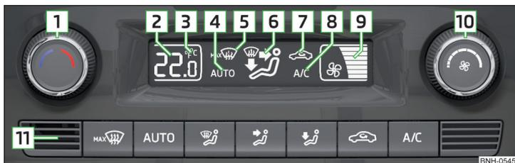
Obr. 92 Ovládací prvky Climatronicu
