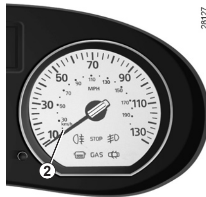
Ukazatel rychlosti 2 Dvoji stupnice pro zobrazení rychlosti (míle a km za hodinu) (podle vybavení vozidla)
