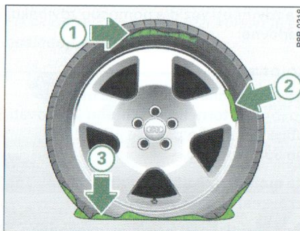
Obr. 279 Poškodenia pneumatiky, pre ktoré nie je vhodný systém Tire-Mobility
