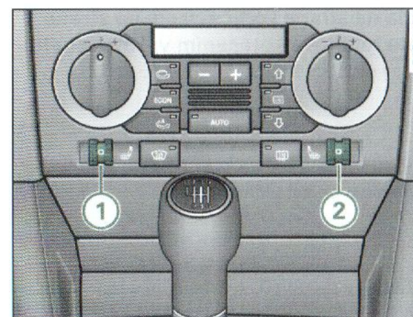
Obr. 155 Zobrazenie časti prístrojovej dosky vo vozidle s klimatizáciou: vrúbkované koliesko regulácie vyhrievania sedadiel
