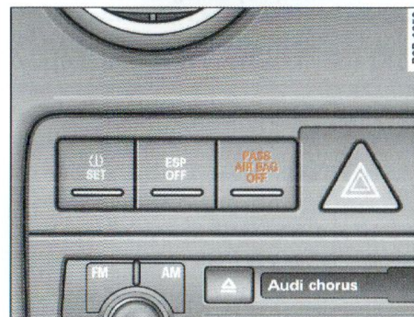
Obr. 219 Výstražné svetlo pri odpojení airbagu spolujazdca pomocou uzamykateľného ovládača
