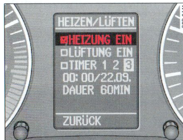
Obr. 152 Celkový pohľad: displej FIS, ponuka Heizen/Lüften (Kúrenie / vetranie), zvolené Heizung Ein (Kúrenie zapnuté)
