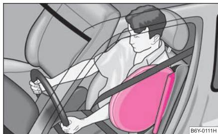
Obr. 149 Plynem naplněné boční airbagy
