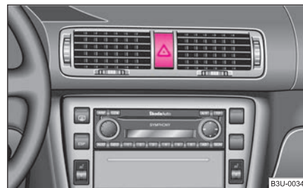
Obr. 38 Přístrojová deska: spínač varovných světel
