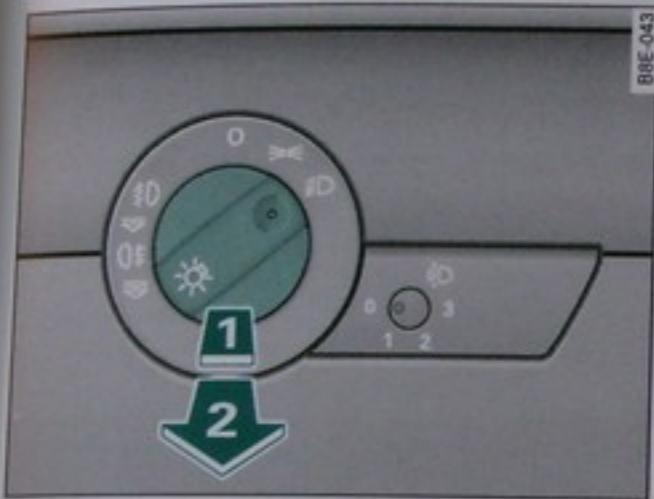
Obr. 60 Zobrazenie časti prístrojovej dosky: prepínač svetiel
