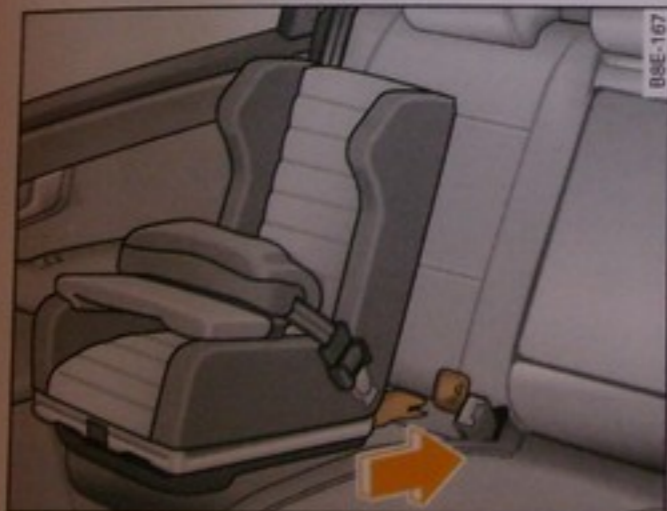
Obr. 193 Detská sedačka ISOFIX sa zasunie do namontovaných upevňovacích uzáverov
