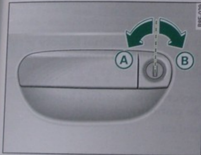
Obr. 46 Otáčanie kľúčom pri odomykaní a uzamykaní
