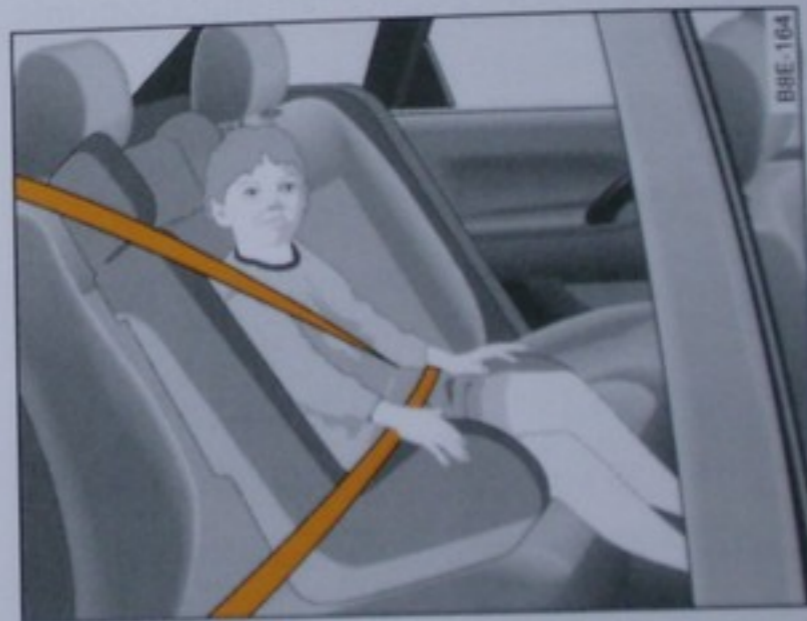
Obr. 190 Detská sedačka skupiny 2 namontovaná v smere jazdy na zadnom sedadle
