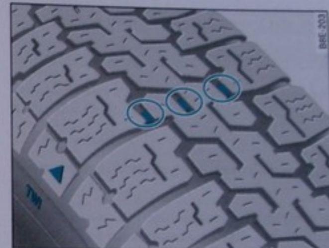
Obr. 227 Profil pneumatiky: ukazovatele opotrebovania
