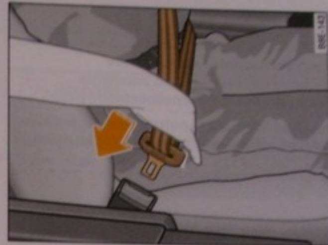
Obr. 169 Sedadlo vodiča: zámka pásu a spona
