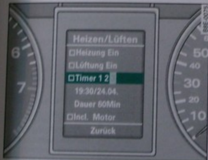
Obr. 127 Celkový pohľad: displej FIS, ponuka Heizen/Lüften (Kúrenie / vetranie) zvolený Timer 3 (časovač 3)
