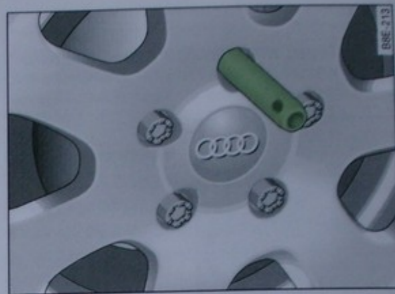
Obr. 241 Výmena kolesa: montážny kolík v najvrchnejšom otvore
