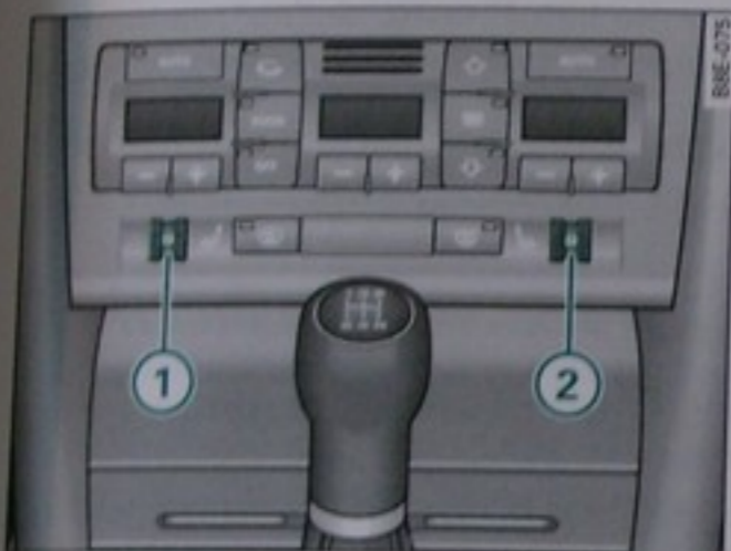
Obr. 90 Zobrazenie časti prístrojovej dosky: vrúbkované koliesko regulácie vyhrievania sedadiel
