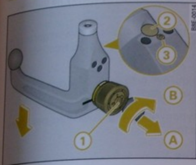
Obr. 203 Snímateľné ťažné zariadenie: napnutie guľovej tyče
