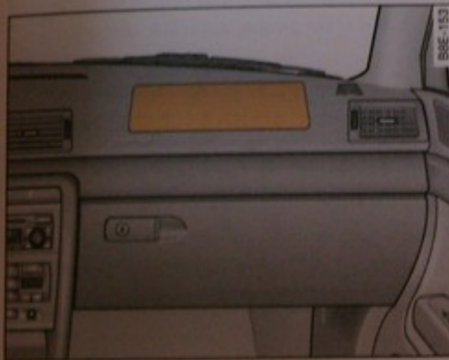
Obr. 177 Airbag pre spolujazdca v palubnej doske
