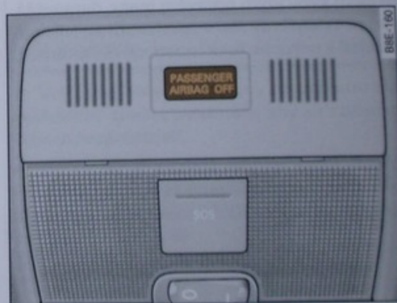
Obr. 185 Výstražné svetlo pri odpojenom airbagu spolujazdca pomocou uzamykateľného ovládača
