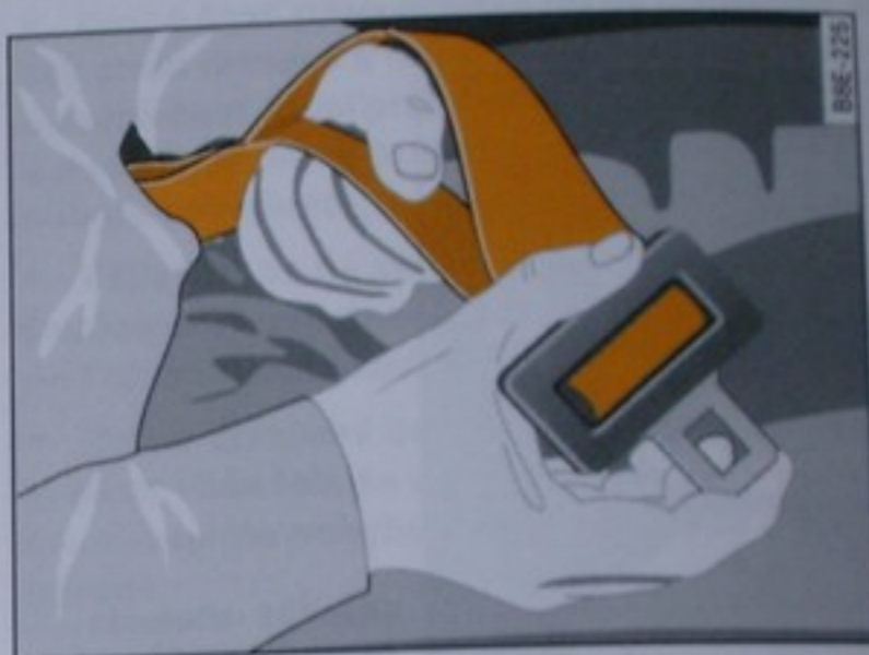
Obr. 173 Bedrový pás: predĺženie pásu
