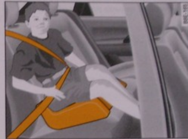
Obr. 191 Detská sedačka skupiny 3 namontovaná v smere jazdy na zadnom sedadle
