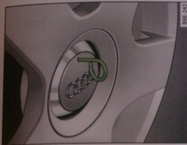
Obr. 235 Výmena kolesa: stiahnutie ozdobného krytu
