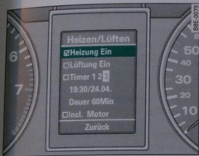
Obr. 132 Celkový pohľad: displej FIS, ponuka Heizen/Lüften (Kúrenie / vetranie) zvolené Heizung Ein (Kúrenie zapnuté)
