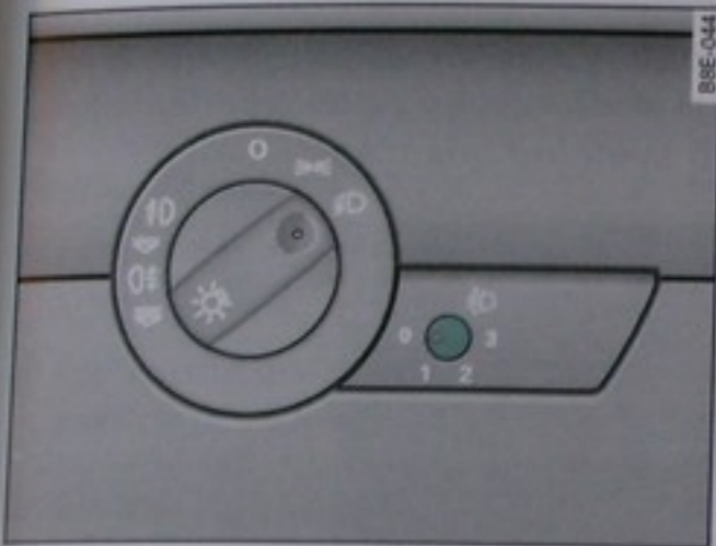
Obr. 62 Regulácia sklonu svetelného kužela svetlometov
