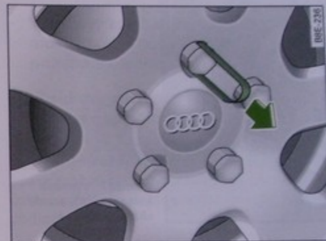
Obr. 236 Výmena kolesa: zloženie čiapočiek
