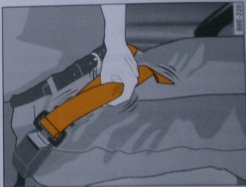
Obr. 174 Bedrový pás: skrátenie pásu
