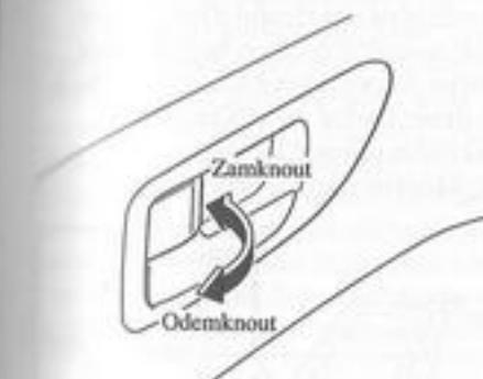
Chcete-li uzamknout přední dveře spolujezdce pomocí vnitřního ovladače zámku vnení, stlačte tento vnitřní ovladač, držte vyklopenou vnější kliku a dveře poté zavřete.
