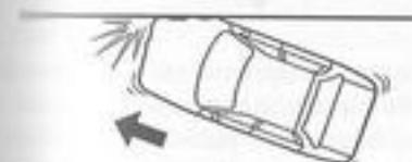
Boční nárazy do stromů nebo sloupů, které sice způsobí závažné kosmetické poškození vozidla, avšak nejsou dostatečně silné, aby došlo k aktivaci bočního\* a okenních\* bezpečnostních vzduchových vakuů.
