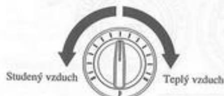
Tento regulátor upravuje teplotu vzduchu. Otáčením ve směru hodinových ručiček teplotu vzduchu zvýšte, otáčením proti směru teplotu vzduchu snížte.
