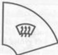
Stisknutím tohoto spínače spustíte vyhřívání čelního okna a oken předních dveří.
