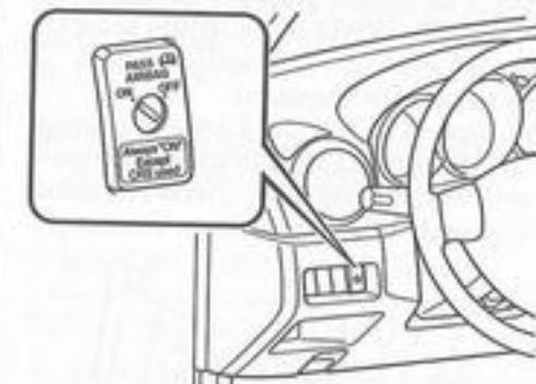
Spínač pro deaktivaci bezpečnostního vzduchového vaku spolujezdce by měl být používán pro deaktivaci tohoto vzduchového vaku v případě, kdy je na sedadle předního spolujezdce instalována dětská bezpečnostní sedačka.
