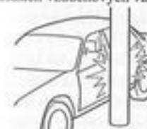
Při převrácení vozidla, kdy nejsou boční sily dostatečné na to, aby došlo k aktivaci bočního\* a okenních\* bezpečnostních vzduchových vakuů.
