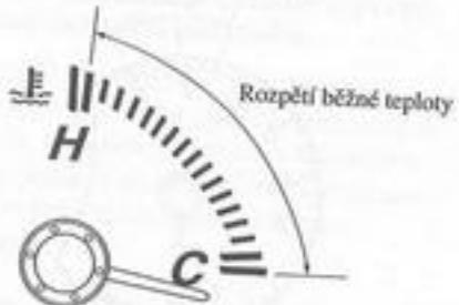
Pokud ručička přístroje překročí hodnotu běžné teploty a přiblíží se ke značce H, signalizuje přehřátí motoru.
