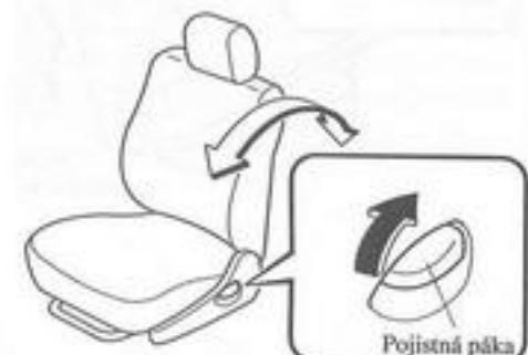
Ujistěte se, zda se pojistná páka vrátila zpět do své původní polohy, a pokuste se opěradlem zakývat vpřed a vzad, abyste se ujistili, zda je ve své poloze zajištěno.
