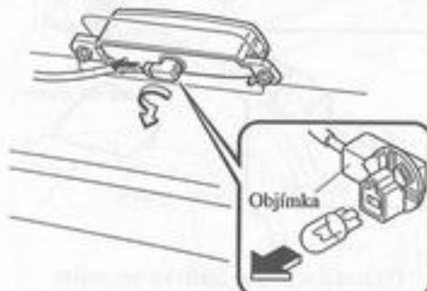
5. Při instalaci nové žárovky provedte výše uvedené kroky v opačném pořadí.
