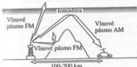
Příjem v pásmu FM může být rovněž ovlivňován atmosférickými podmínkami. Vysoká vlhkost způsobuje špatný příjem. Oblačné počasí však může zajistovat lepší příjem než za jasných dnů.
