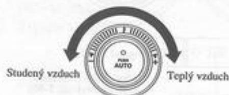
Tímto regulátorem je řízena teplota vzduchu. Otáčením ve směru hodinových ručiček teplotu vzduchu zvýšte, otáčením proti směru teplotu vzduchu snížte.
