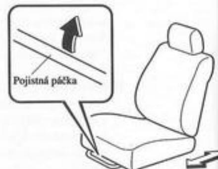
Ujistěte se, zda se pojistná páka vrátila do své původní polohy, a posunutím sedadla vpřed a vzad se ujistěte, zda je ve své poloze bezpečně zajištěno.
