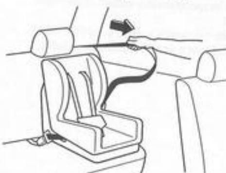
3. Usaďte dětskou bezpečnostní sedačku pevně na sedadlo vozidla. Ujistěte se zda byl bezpečnostní pás navinut co nejpevněji. Pokud je bezpečnostní pás v automatickém blokovacím režimu bude v průběhu zpětného navijení pásu slyšet cvakání samonavijecího mechanismu. Jestliže se bezpečnostní pás nezablokuje, zopakujte tento krok.
