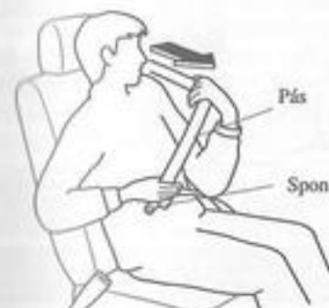
Vložte sponu pásu do zámku tak, abyste zaslechli zaklapnutí.
