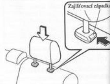
Opěrky hlavy nastavte tak, aby jejich horní hrana dosahovala úrovni uší cestujících, v žádném případě úrovni krku.
