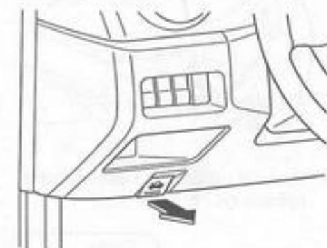
2. Odsuňte bezpečnostní pojistku a kapotu otevřete.
