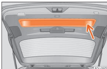
Obr. 139 Otevřené zadní víko: zapuštěné madlo pro zavírání zavazadlového prostoru
