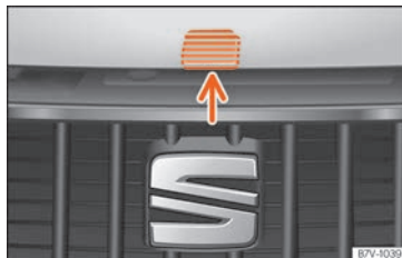
Obr. 13 Páčka pod víkem motorového prostoru.
