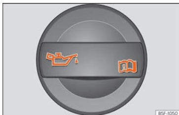
Obr. 292 V motorovém prostoru: víko plnicího otvoru motorového oleje.
