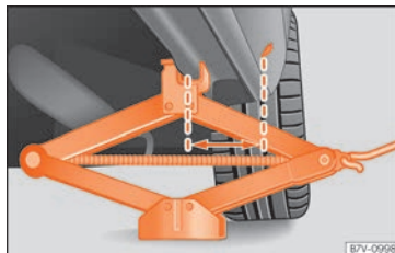
Obr. 72 Nasazení palubního zvedáku vzadu na levé straně vozidla.
