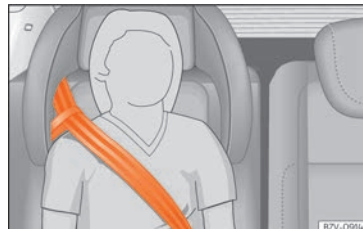
Obr. 98 Integrovaná dětská sedačka: průběh pásu s vodícím třmenem
