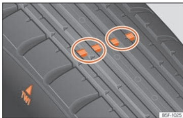
Obr. 302 Vzorek pneumatiky: ukazatele opotřebení.
