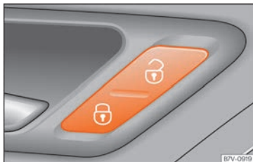
Obr. 132 U dveří řidiče: tlačítko centrálního zamykání dveří.
