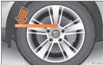
Obr. 69 Výměna kola: povolte šrouby kol.
