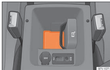
Obr. 124 Středová opěrka vpředu: uchycení pro spojení mobilního telefonu s vnější anténou vozidla.
