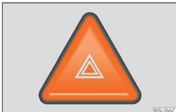
Obr. 44 Přístrojová deska: Spínač výstražných světel
