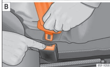
Obr. 23 Jazýček spony bezpečnostního pásu zasuňte do zámku a uvolněte ze zámku.
