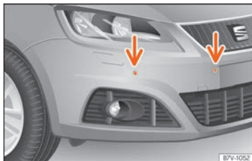
Obr. 247 Snímače kontroly vzdálenosti při parkování vpředu v nárazníku
