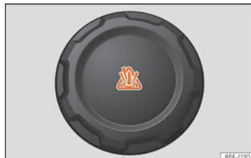
Obr. 295 V motorovém prostoru: uzávěr vyrovnávací nádržky chladicí kapaliny motoru.
