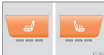
Obr. 159 Detail středové konzole: Regulator vyhřívání předních sedadel u vozidel s Climatronic.
