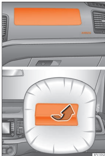
Obr. 28 Montážní poloha a oblast účinnosti čelního airbagu spolujezdce
