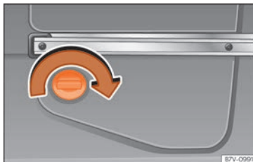
Obr. 288 V zadní části zavazadlového prostoru vlevo: nádržka pro AdBlue za krytem.
