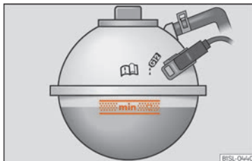
Obr. 294 V motorovém prostoru: značka na vyrovnávací nádržce chladicí kapaliny motoru.
