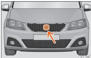
Obr. 263 V přední části za logem SEAT: radarový snímač.
