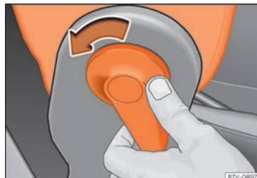
Obr. 164 Odjističení sklápěcího opěradla sedadla spolujezdce
