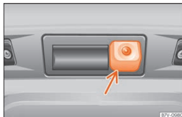
Obr. 253 V zadním víku: umístění kamery asistenta pro zpětnou jízdu.
