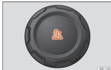
Obr. 58 Motorový prostor: uzávěr vyrovnávací nádržky chladicí kapaliny motoru
