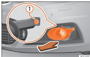
Obr. 111 Přední nárazník vpravo: demontáž světlometů.
