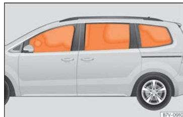
Obr. 35 Nafouknuté hlavové airbagy.
