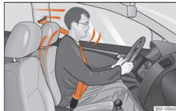
Obr. 86 Zachycení správně připoutaného řidiče bezpečnostním pásem během prudkého zabrzdění.
