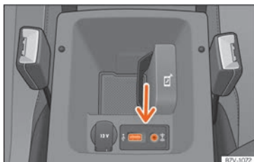
Obr. 123 Středová loketní opěrka vpředu: Přípojka USB/AUX-IN.
