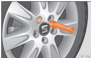
Obr. 73 Výměna kola: našroubování šroubů kol rukojetí šroubováku.
