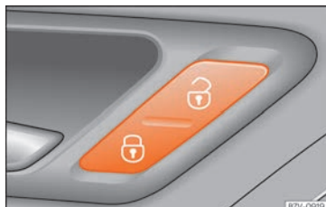
Obr. 4 U dveří řidiče: tlačítka centrálního zamknutí dveří.
