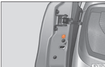
Obr. 6 Na přední části posuvných dveří: nouzové zamykání, zakryto gumovým těsněním.
