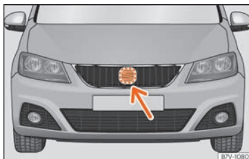
Obr. 259 V přední části za logem SEAT: radarový snímač.
