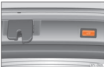
Obr. 140 Tlačítko v otevřeném zadním víku.
