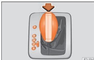
Obr. 51 Automatická převodovka: Polohy volící páky.
