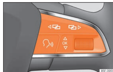
Obr. 47 Multifunkční volant: tlačítka k ovládání nabídek ve sdružených přístrojích
