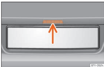
Obr. 141 Otevírání zadního víka zvenčí.
