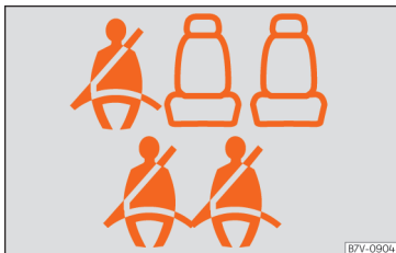
Obr. 85 Příklad pro zobrazení stavu bezpečnostního pásu na zadních sedadlech (zde u 7místné verze) v panelu přístrojů: nahoře druhá řada sedadel, dole třetí řada sedadel.
