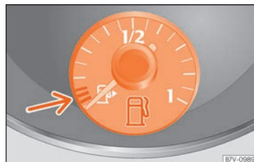
Obr. 285 Panel přístrojů: ukazatel zásoby benzínu nebo motorové nafty.
