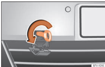
Obr. 74 Přední nárazník vpravo: našroubování vlečného oka.
