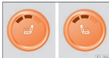
Obr. 158 Detail středové konzole: ovladače vyhřívání předních sedadel, zde při nastaveném druhém stupni vyhřívání
