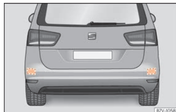
Obr. 272 Oblast za vozidlem: Oblasti radarových snímačů.
