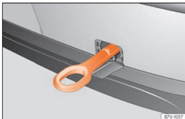
Obr. 75 Zadní nárazník vpravo: zašroubování vlečné oko.
