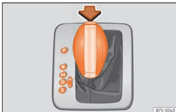
Obr. 241 volicí páka automatické převodovky s blokovacím tlačítkem (šipka)
