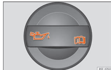
Obr. 57 Víko otvoru pro plnicí otvor motorového oleje
