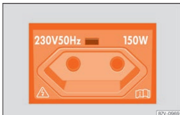
Obr. 198 Detail zadní středové konzole: euro-zásuvka 230 V.
