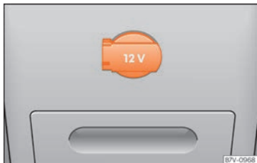
Obr. 197 Zadní strana středové konzole: zásuvka 12 V.
