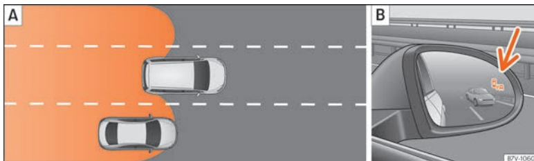
Obr. 274 Schématické zobrazení: A Předjíždění a následně zařazení do pravého jízdního pruhu. B Zobrazení asistenta Blind-Spot ve vnějším zrcátku vpravo.
