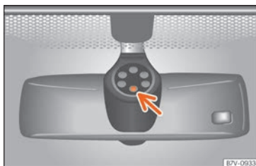
Obr. 149 Citlivá plocha dešťového snímače.
