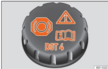
Obr. 296 V motorovém prostoru: uzávěr nádrže brzdové kapaliny
