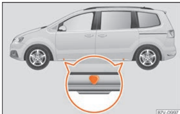
Obr. 71 Upínací body pro nasazení zvedáku.
