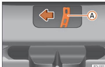
Obr. 11 Ze zavazadlového prostoru: nouzově odemkněte zadní víko.
