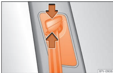
Obr. 92 U předních sedadel: nastavení výšky pásu
