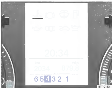
Obr. 105 Sdružené přístroje: ukazatel řazení se zařazeným 4. rychlostním stupněm tiptroniku
