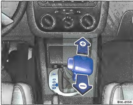
Obr. 103 Středová konzola: automatická/přímá řazená převodovka v poloze tiptronic
