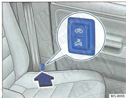
Obr. 29 Tlačítko k vypnutí hlídání vnitřního prostoru a ochrany proti odtažení vozidla
