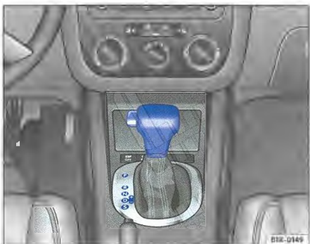
Obr. 101 Středová konzola: volicí páka automatické/přímo řazené převodovky
