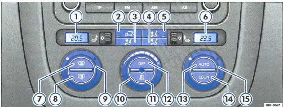
Obr. 92 Ve středové konzole: ovládací prvky climatroniku
