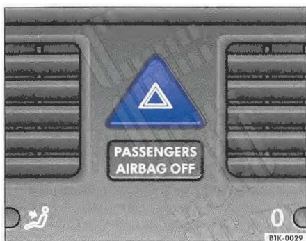
Obr. 39 Přístrojová deska: spínač varovných světel
