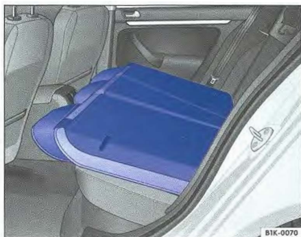
Obr. 63 Sklopení zadního opěradla
