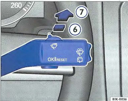
Obr. 48 Páčka stěračů a ostřikovačů: stěrač skla zadních výklopných dveří
