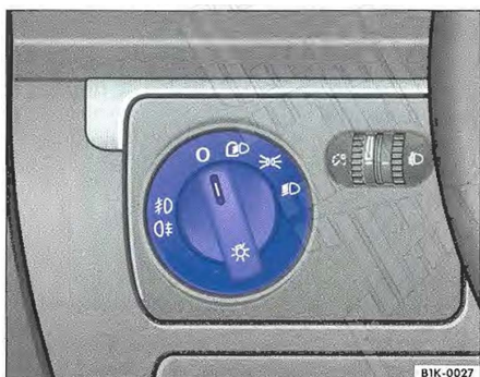
Obr. 37 Přístrojová deska: spínač světel, mlhových světlometů a mlhového koncového světla
