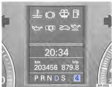
Obr. 104 Sdružené přístroje: ukazatel polohy volicí páky se zařazenou polohou D a 4. jízdním stupněm
