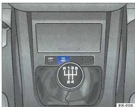
Obr. 15 Sříedová konzola: tlačítko ukazatele kontroly pneumatik
