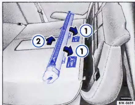
Obr. 120 Montáž síťové oddělovací stěny na zadní opěradla.
