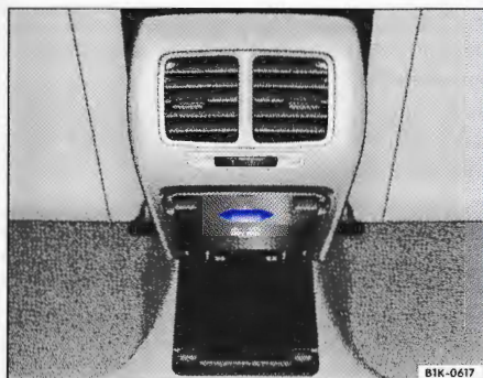
Obr. 109 Středová konzola vzadu: eurozásuvka 230 V
