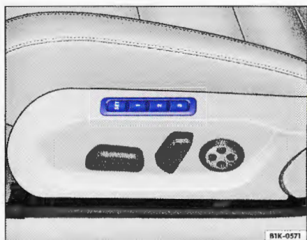
Obr. 74 Paměťová tlačítka na sedadle řidiče: při ukládání stisknete nejprve tlačítko SET a potom paměťové tlačítko 1, 2 nebo 3.
