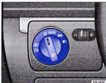
Obr. 44 Přístrojová deska: spínač světel, automatické ovládání tlumených světel, mlhových světlometů a mlhového koncového světla
