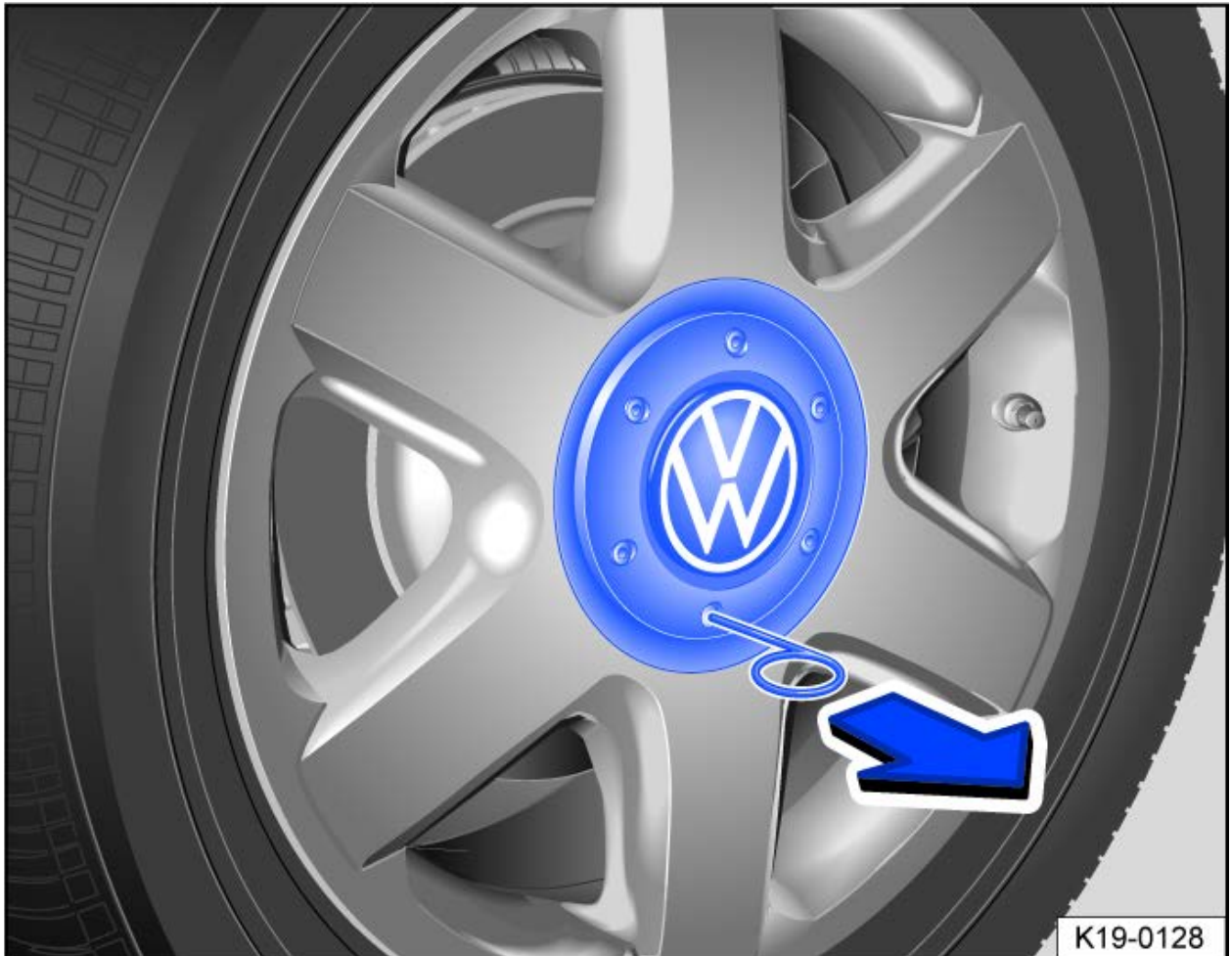
Fig. 1 Remove the wheel center trim.
