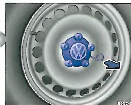
Obr. 28 Stiahnutie ozdobného stredového krytu kolesa
