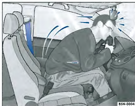
Obr. 11 Nepripútaný vodič je vymrštený smerom dopredu.
