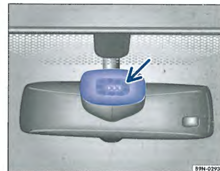
Obr. 53 Citlivá plocha senzora dažďa.
