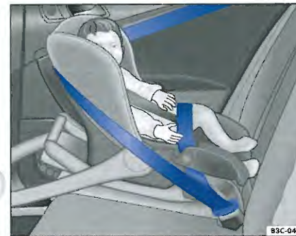
Obr. 33 Detská sedačka skupiny 0 namontovaná chrbtom k smeru jazdy na zadnom sedadle.
