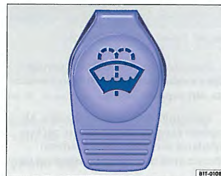
Obr. 12 V priestore motora: modrý kryt nádržky kvapaliny ostrekovačov skiel.
