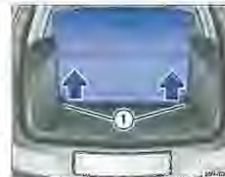
Obr. 115 Zdvíhnutie podlahy batožinového priestoru.
