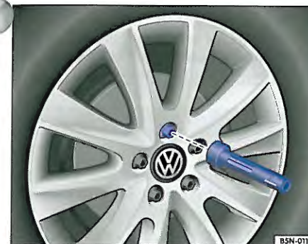
Obr. 34 Výmena kolesa: Odskrutkovanie skrutiek kolies pomocou rukoväte skrutkovača.
