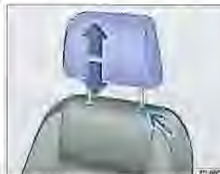
Obr. 59 Nastavenie alebo demontáž prednej opierky hlavy.
