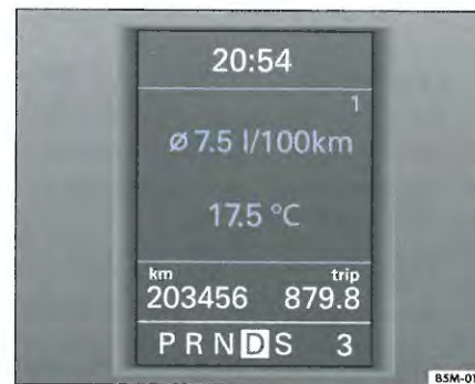
Obr. 13 Displej združeného prístroja: Multifunkčný ukazovateľ (MFA).
