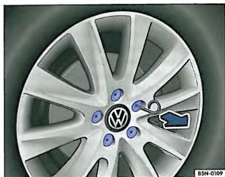
Obr. 29 Zloženie protiprachových krytov zo skrutiek kolesa.
