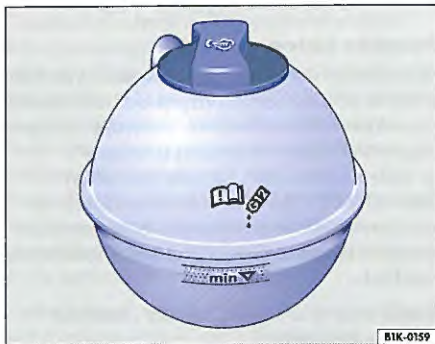
Obr. 10 V priestore motora: Vyrovnávacia nádržka chladiacej kvapaliny.
