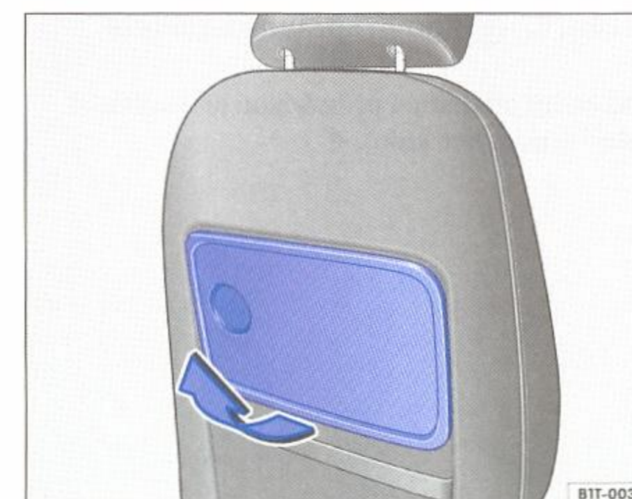
Obr. 86 Sklopný stolek v opěradle předního sedadla
