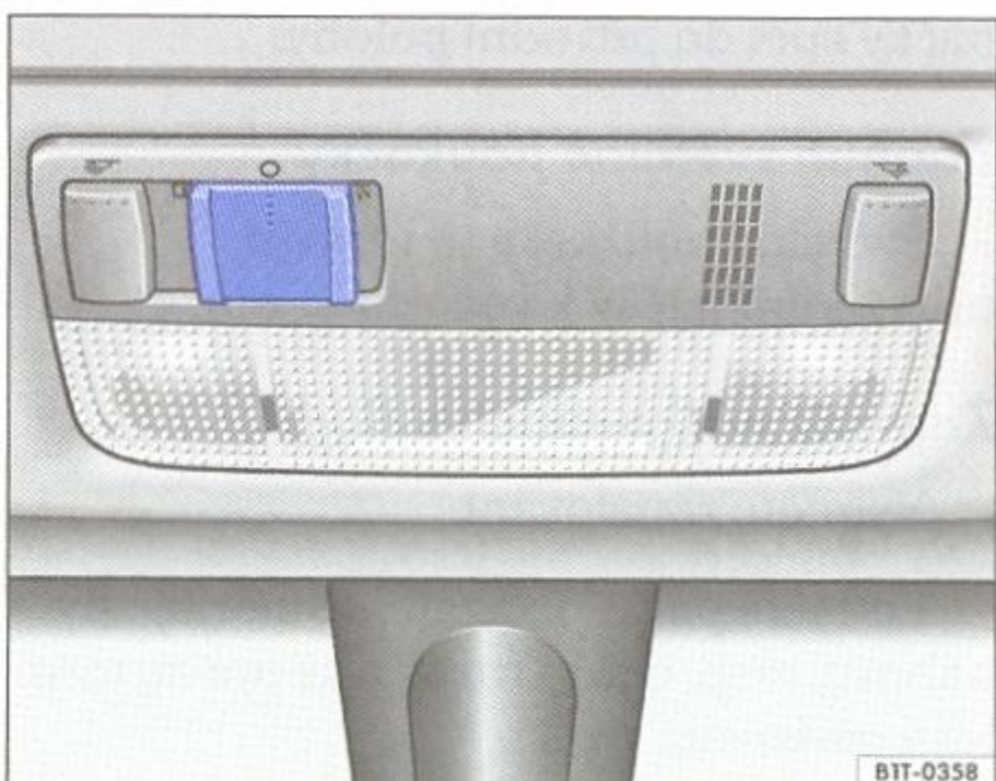
Obr. 42 Podhled střechy: spínač vnitřního osvětlení vpředu
