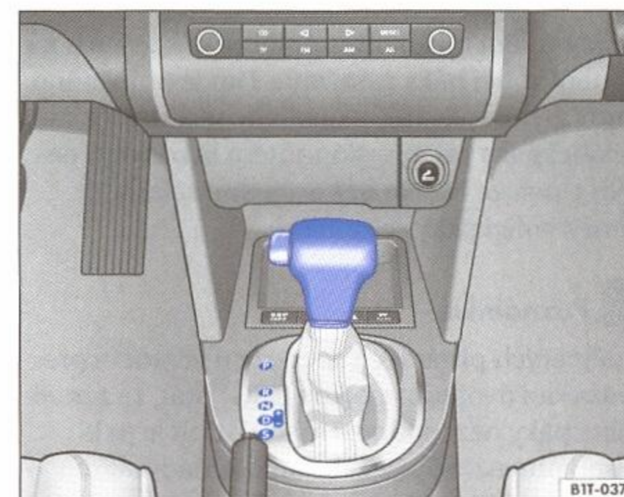
Obr. 119 Středová konzola: volicí páka automatické převodovky nebo převodovky s dvojitou spojkou DSG
