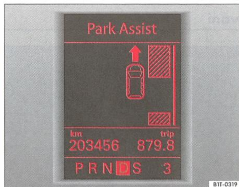
Obr. 133 Na displeji sdružených přístrojů se objeví: Parklücke erkannt mit dem Hinweis weiter vorzufahren (zjištěna mezera k zaparkování s pokynem k dalšímu najetí)
