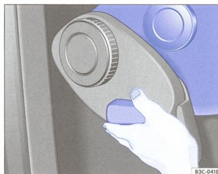
Obr. 58 Odjistění sklápěcího sedadla spolujezdce
