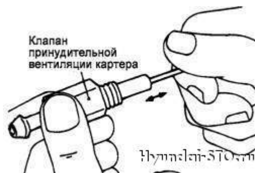
Obr. 2.353 Kontrola pohybu pístu
