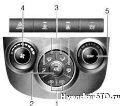
Obr. 1.111 . 1.111 , Panel topení a větrání: 1 - přepínač režimu sání vzduchu, 2 - vzduch-kondicionér přepínač 3 - přepínač pro výběr způsobu větrání, 4 - přepínač režimu otáček ventilátoru, 5 - přepínač pro nastavení teploty vzduchu
