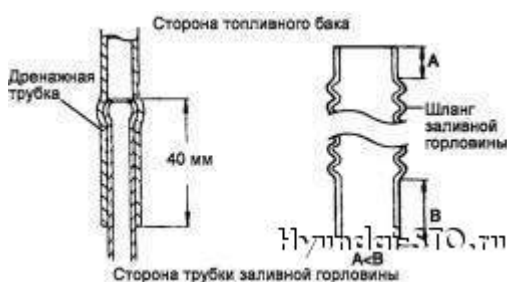
Obr. 2.400 Režim pro připojení hadice výplň
