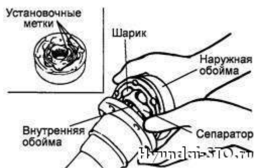
Obr. 3.111 Situace koule a separator
