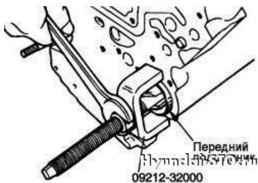
Obr. 2.97 Demontáž pravé přední ložisko vyvažovací hřídel
