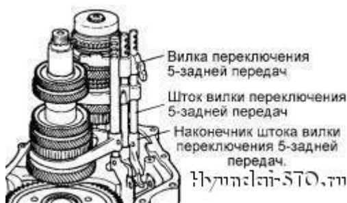
Obr. Sklad vidlice switch 5-zadní ozubená kola, vidlice 5-shift ozubených kol a zadní vidlice kmenových tip switch 5-zadní zařízení
