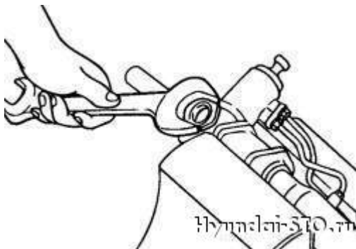
Obr. 5.32 Otvorachivanje ořechy lišty lid zámek
