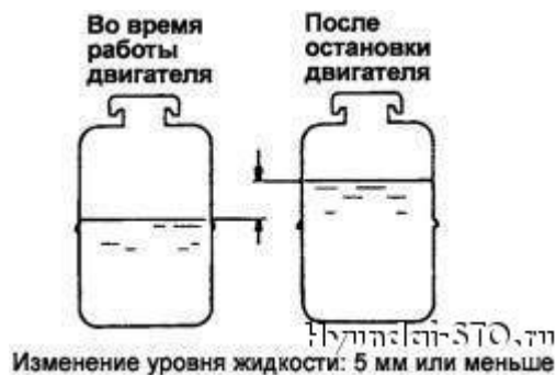
Obr. 5.9 Rozdíl hladiny kapalin v hydraulických nádrží před a po osnanovki Motor
