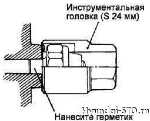
Obr. 2.86 Demontáž čidla tlaku oleje- spínač
