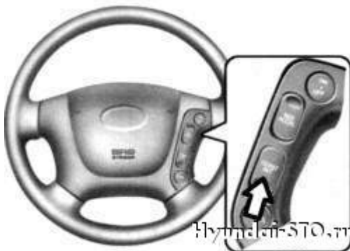
Obr. 1.105 . 1.105. Tlačítko "SET" režim tempomat
