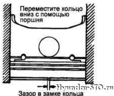
Obr. 2.144 Kontrola mezeru v zámku kroužku pístu
