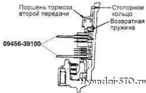
Obr. 3.76 Schéma řízení axiální vůle brzdového druhý převod
