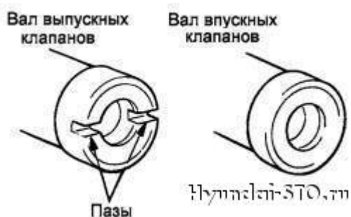
Obr. 2.47 Slot pro instalaci snímače polohy klikového hřídele
