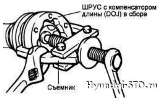
Obr. 3.112 Odstranění vnitřních klipy a odlučovače konstantní rychlost spoje z přední vrtulové hřídele
