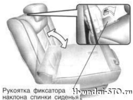
Obr. 1.154 Úhel opěradla zadního sedadla
