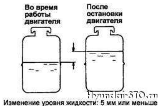
Obr. 5.9 Rozdíl hladiny kapalin v hydraulických nádržích před a po osnanovki Motor
