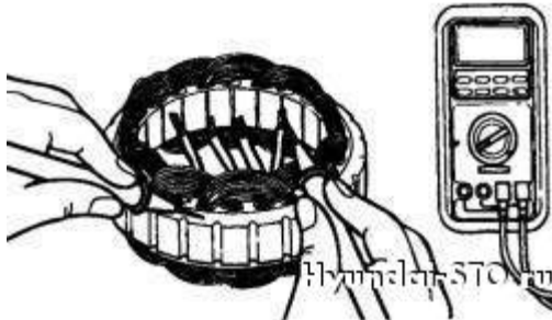
Obr. 7.43 Kontrola absence uzavření statorového vinutí "hmoty"
