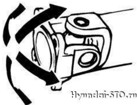
Obr. 3.99 Zkontrolujte plynulost pohybu kardanových kloubů
