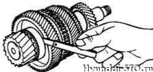
Obr. 3.38 Měření rozdíl mezi druhým střední převodovkou a střední zařízení třetím rychlostním stupni
