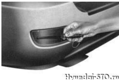
Obr. 1.244 Otvorachivanje kterým vinotov
