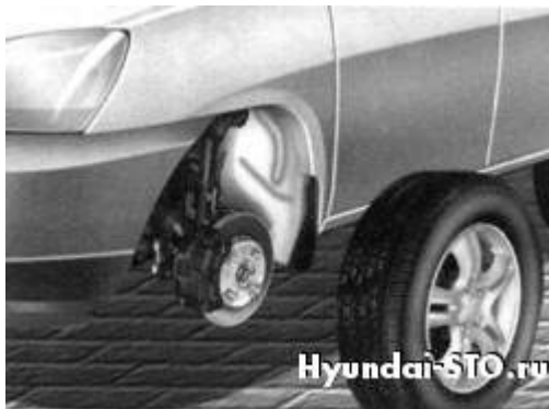
Obr. 1.200 Instalace nové kolo
