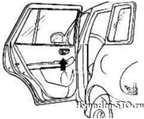
Obr. 8.21 . Šroub vnitřní kliky dveří čalounění
