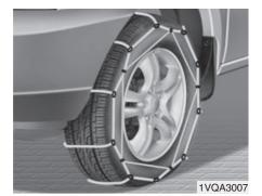
Mivel a radiál gumiabroncsok oldalfala vékonyabb, megsérülhetnek bizonyos fajtájú hólánc felszerelésétől. Ezért inkább javasoljuk a téli gumiabroncsok használatát, mint a hólánc használatát. Ne szereljen fel hóláncot alumínium keréktárcsás kerékre, mivel a hólánc sérüléseket okozhat a keréktárcsán. Ha mégis hóláncot kellene használnia, használion 15 mm-es átmérőnél kisebb, kábeltípusú hóláncot. Gépkocsijának a hólánc helytelen használatából eredő káraira nem vonatkozik a garancia.
