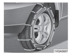
Da siderne på radialdæk er tyndere, kan de blive beskadiget af montering af nogle typer snekæder. Derfor anbefales brugen af vinterdæk i stedet for snekæder. Undgå at montere snekæder på biler udstyret med aluminiumsfælge, fordi snekæder kan beskadige hjulene. Hvis der skal bruges snekæder, skal De bruge snekæder af wiretypen med en tykkelse på mindre end 15 mm. Skader, forårsaget af ukorrekte snekæder, dækkes ikke af Deres bils fabriksgaranti.
