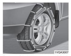
Ponieważ ścianki boczne opon radialnych sa cieńsze, założenie niektórych rodzajów łańcuchów śniegowych może spowodować ich uszkodzenie. Z tego względu zaleca się korzystanie z opon zimowych zamiast łańcuchów śniegowych. Łańcuchów śniegowych nie należy zakładać w pojazdach, które są wyposażone w felgi aluminiowe, ponieważ moga one powodować uszkodzenia felg. Jeśli użycie łańcuchów śniegowych jest niezbędne, należy zastosować łańcuchy drutowe o grubości poniżej 15 mm.
